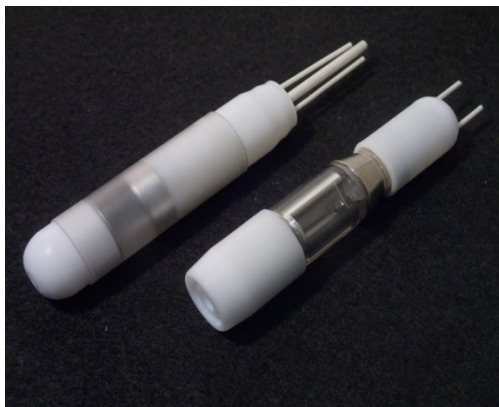
Рис.1 Миниатюрный источник рентгеновского излучения [1]
